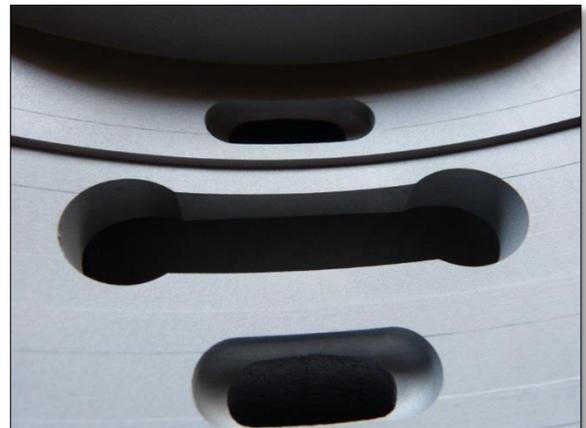
Kolben nach der Bearbeitung mit dem GEOStrahlen
