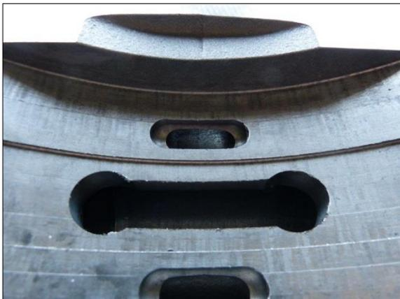
Kolben nach der Zerspangung
